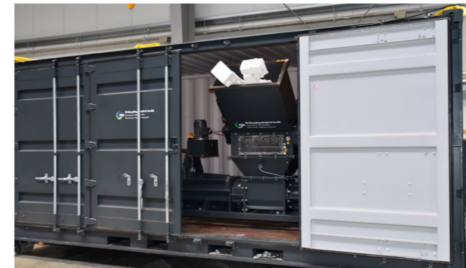
Direkt auf der Baustelle: der Styropor-Verdichter von FZ-Recycling
