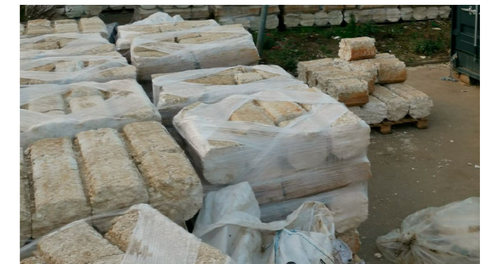
Die verdichteten Materialblöcke können einfach zum Recyceln transportiert werden
