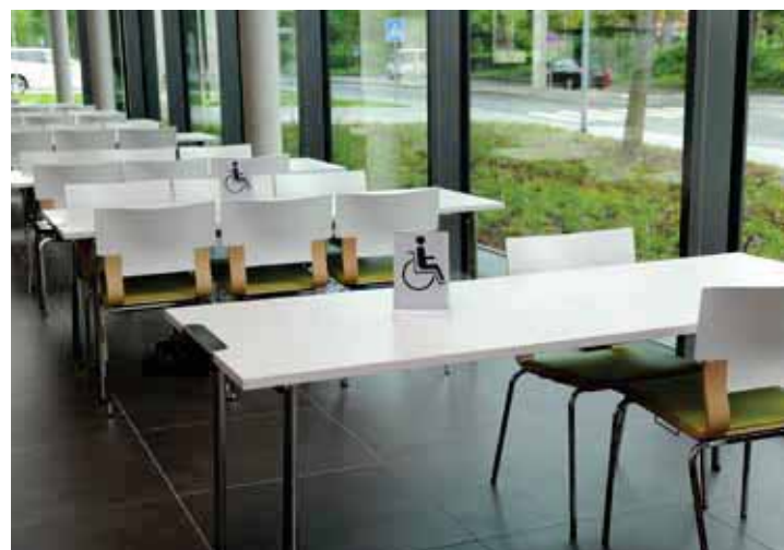
154 – 155 Unterfahrbare Tische mit zusätzlichen Haltern für Gehstöcke und Unterarmstützen
