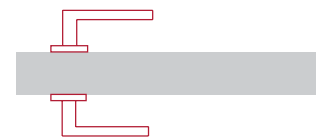
31 – 32 Geeignete Drückerformen – mit gebogenem und mit längerem Griffteil (U- und L-förmige Griffe)
