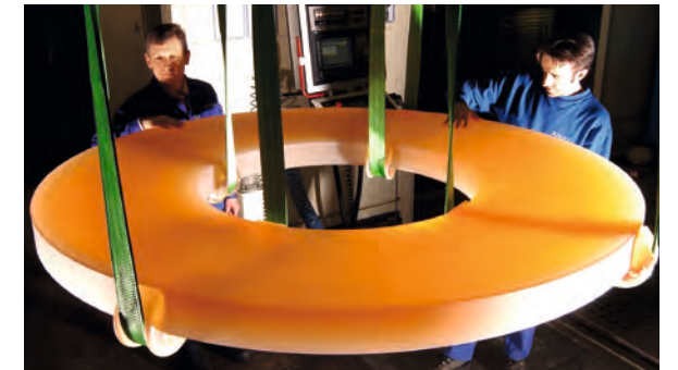
Für den Blick ins Weltall: Herstellung eines Spiegelträgers für ein Teleskop bei der Schott AG.
