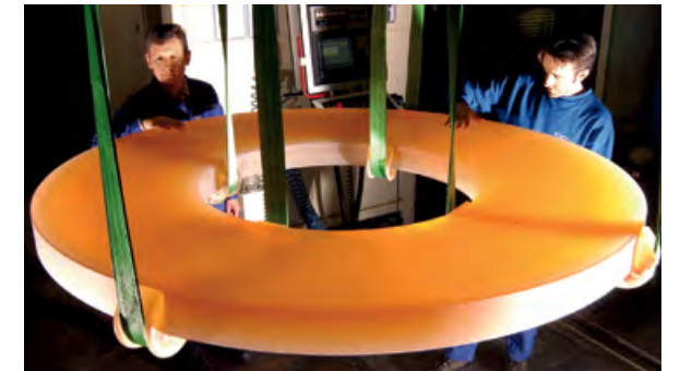
Observation de l'espace : Fabrication d'un substrat de miroir pour un télescope au sein de la société Schott AG
