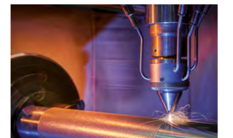
EHLA: extremes Hochgeschwindigkeits-Laserauftragsschweißen
